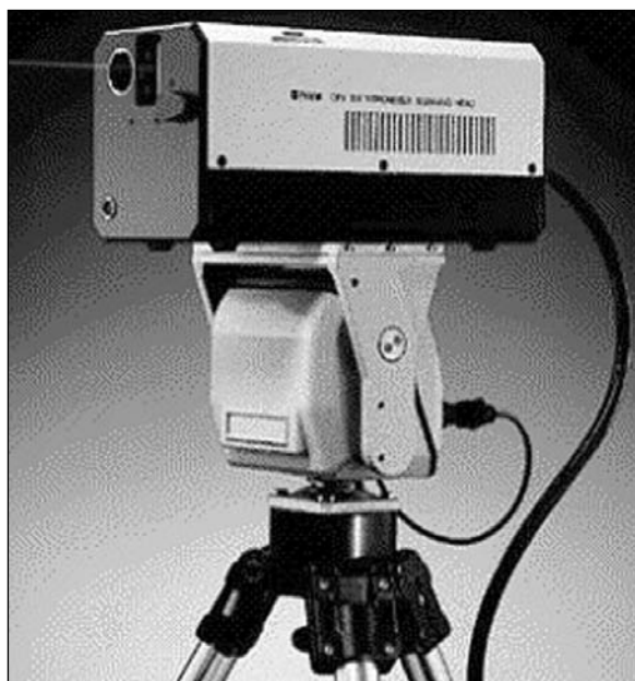
Obr. 5. Skanovací laserový vibrometr fy Polytec PI
