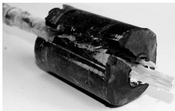
Obr. 2. Příčné roztržení kotevního válečku
