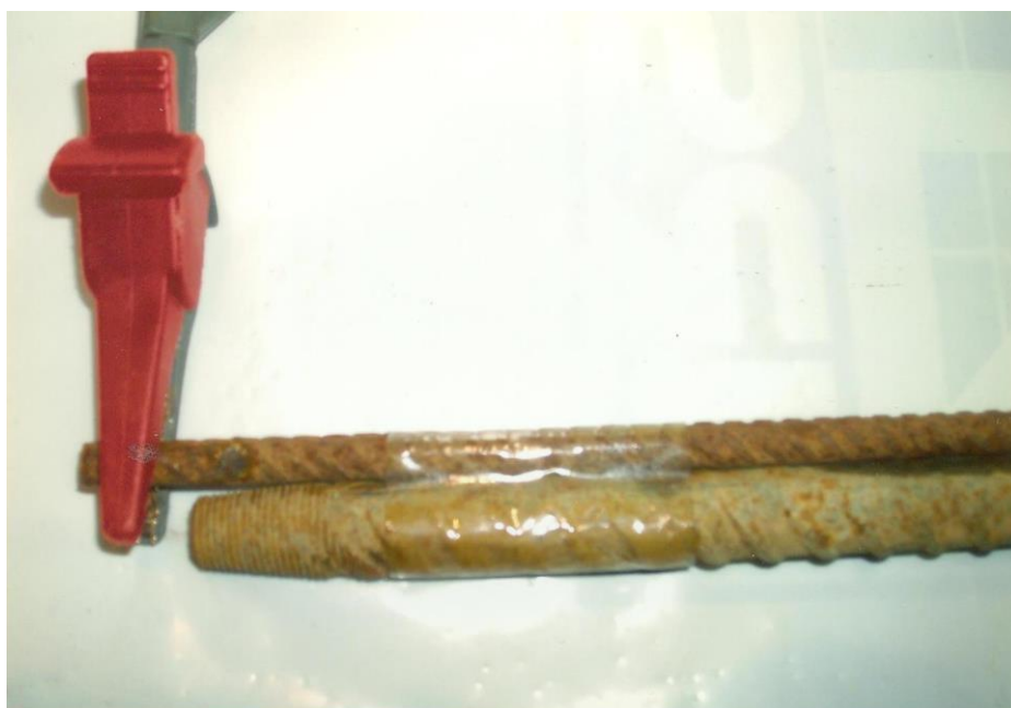
Obr. 1-4 Detail připojení krokodýlku k výztuži R8 a způsob simulace přesahu výztuže R18/R8 při použití lepicí pásky o šířce 50 mm
