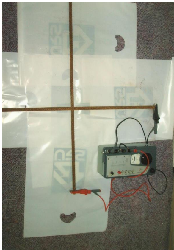
Obr. 1-3 Pohled na měřicí obvod ke stanovení přechodového odporu v případě křížení výztuže R14/R14
