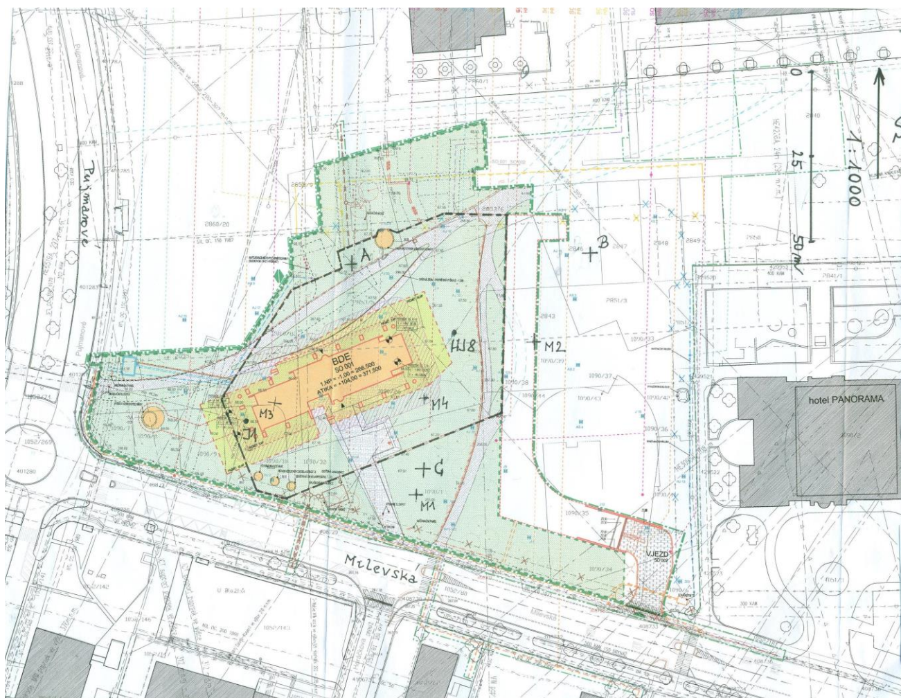
Obr. 1-3 Koordinační situace s vyznačením míst, kde bylo provedeno šetření v rámci korozního průzkumu (body A, B, C, M1-M4 a sondy J1, HJ8)
