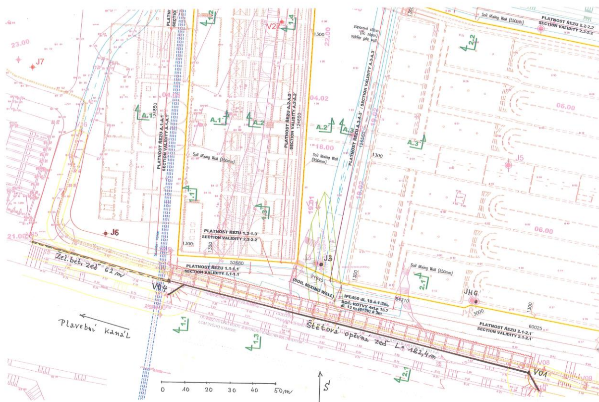
Obr. 5-2 Situace štětové opěrné zdi a železobetonové zdi
