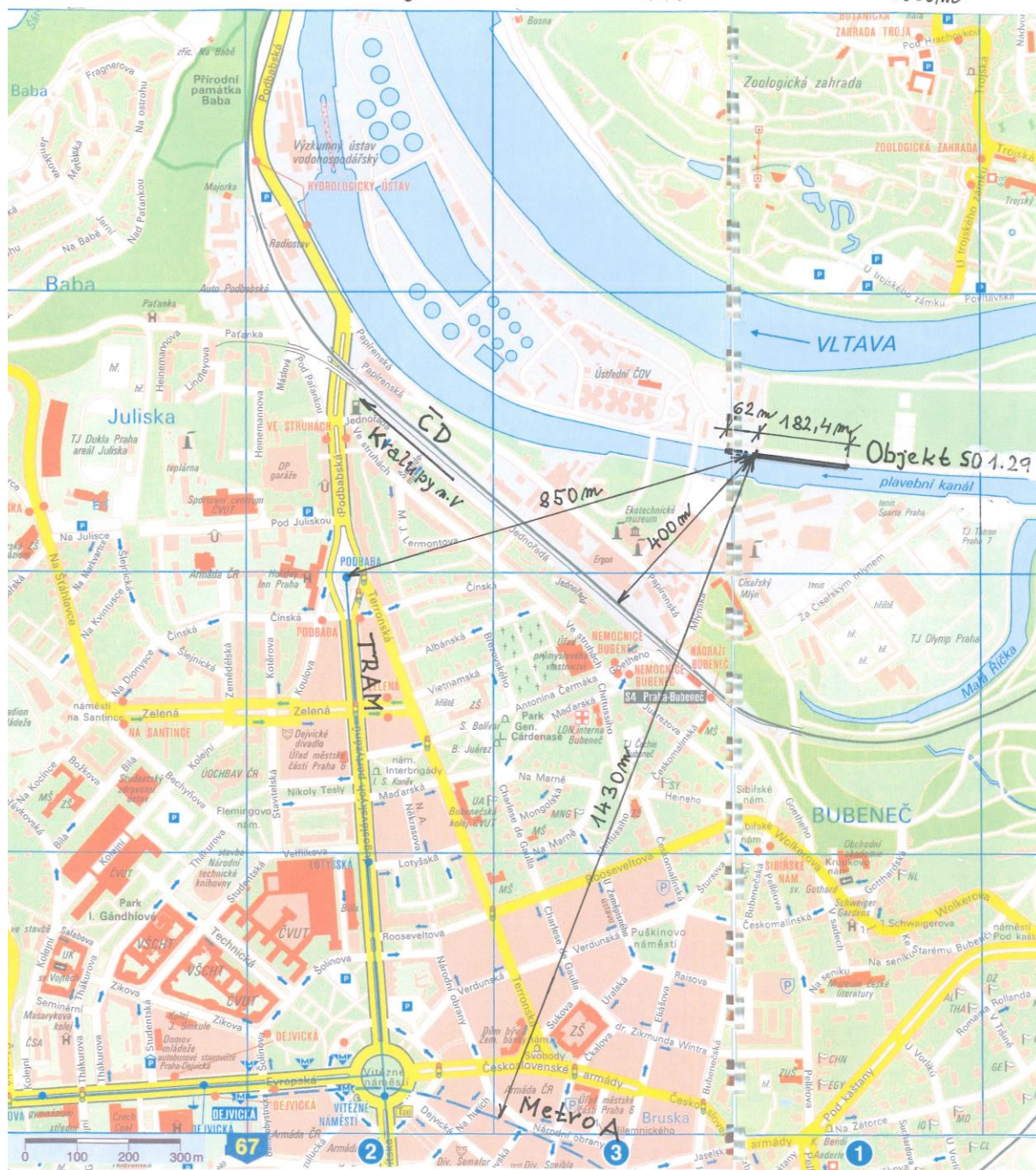
Obr. 5-1 Situace širších vztahů opěrné nábrežní zdi přístaviště s vyznačením zdrojů bludných proudů
