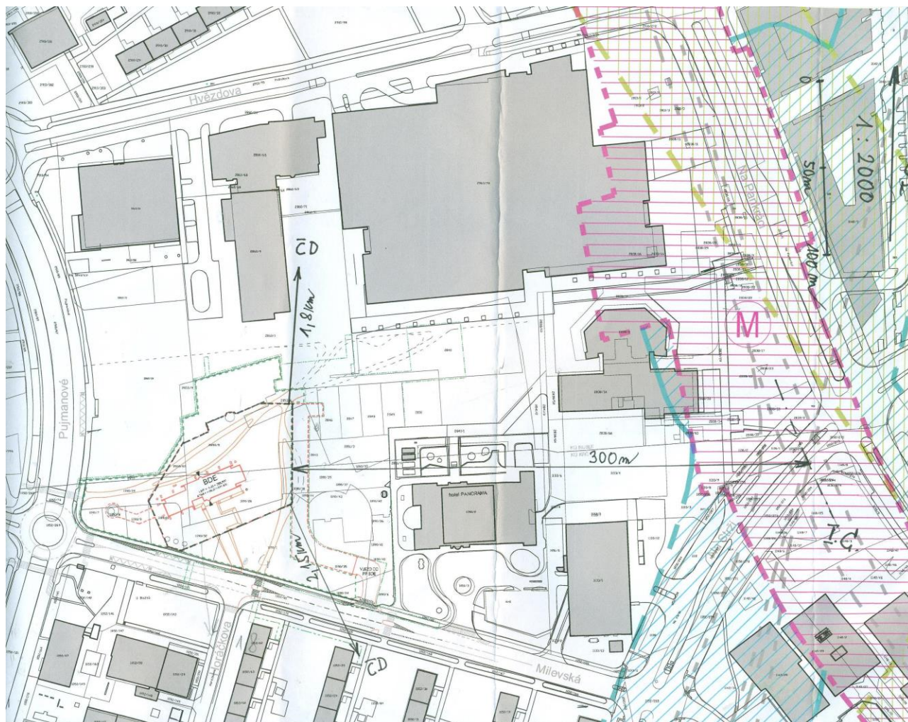
Obr. 1-2 Situace širších vztahů s vyznačením vzdálenosti od zdrojů bludných proudů
